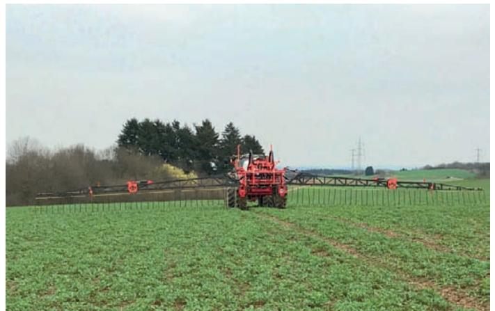
Alle Maschinen mit 3000l Inhalt, Frischwassertank 300l, Handwaschtank 20 l, Pumpe 262l/20 bar, vollhydr. Klappung mit variabler Geometrie, hydr. Hangausgleich, 7 Teilbreiten (9 bei 27 m), hydr. Parallelogrammführung, hydr. Federung des Gestängeträgers, 3-fach Düsensträger mit Lechler Düsen, Steuerung Isobus Elektronik, Obenanhängung mit vollelekt. Lenkdeichsel, Druckluft-Bremsanlage, BPW-Achse mit TÜV-Gutachten 40 km/h, Beleuchtung, Bereifung 340/85 R48 mit Kotflügel.
